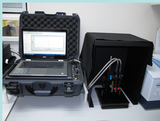
圖3: 美國雙光源激光拉曼光譜儀 ProDD-EZRaman DUAL-Raman System , TopTek-Enwave Optronics, Inc, USA
